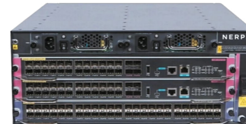
Коммутаторы агрегации и ядра
